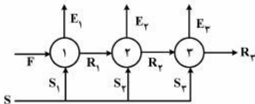
$$\text{مقدار ثابت در هر چهار روش} = S = S_1 + S_2 + S_3$$
