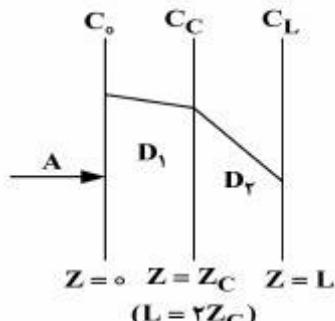
$$D_1(C_0 - C_L) = D_2(C_C - C_L) \quad (1)$$
