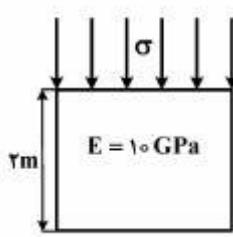
$$(\gamma_{ave} = 0.027 \frac{\text{MN}}{\text{m}^3}) \quad (\Delta L) \quad \text{چند میلی متر است.}$$
