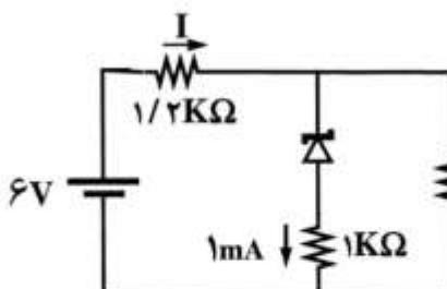
۱۰۸ - در مدار شکل زیر مقدار جریان  $I$  چند میلی آمپر است؟ ( $V_Z = 2V$ )
