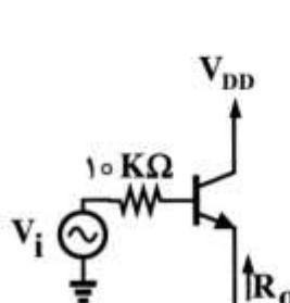
۱۰۹ - در مدار شکل زیر مقاومت  $R_o$  چند  $k\Omega$  است؟ ( $r_\pi = 1k\Omega$  و  $\beta = ۹۹$ )
