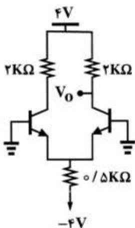
۱۱۰ - در مدار شکل زیر ولتاژ  $V_o$  چند ولت است؟ ( $V_{BE} = ۰.۷V$ )
