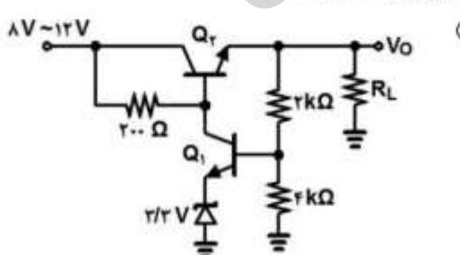
(فرض کنید:  $\beta = ۱۰۰$  و  $I_{Z,min} = ۴mA$  ،  $V_{BE(ON)} = ۰.۷V$ )
