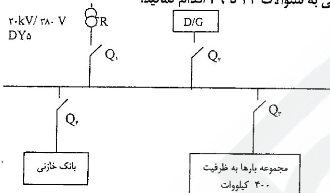
شبکه توزیعی همانند شکل بالا مفروض است مقدار بار مصرفی ببروی شکل مشخص شده است شرایط محیطی ۴۵ درجه سانتیگراد و ارتفاع از سطح دریا ۱۸۰۰ متر می‌باشد ضریب توان برابر ۰/۸ می‌باشد.
