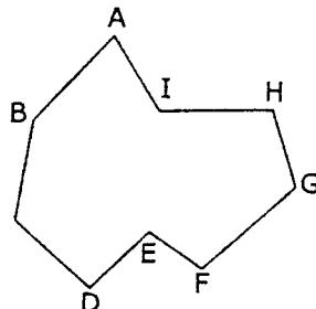
الف) با تقسیم زمین به دو چند ضلعی از طریق وصل کردن نقاط E و I و اندازه‌گیری اضلاع دو چند ضلعی بدست آمده.
