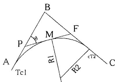
۴۹- جهت اتصال دو مسیر مستقیم  $BC$ ,  $AB$  از قوس مرکب ساده (دو مرکزی) استفاده گردیده است. چنانچه شعاع قوس اول  $R = 300$  متر و زاویه انحراف آن  $20^\circ$  درجه باشد، طول قوس دوم چه مقدار است؟ (در صورتی که مختصات نقاط  $C$ ,  $B$ ,  $A$  مطابق باشند).
