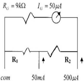
۶۱- برای توسعه حدود اندازه گیری جریان یک گالوانومتر قاب گردان از شنت آئرتون مطابق شکل زیر استفاده شده است . مقاومت  $R_1$  چند اهم است ؟
