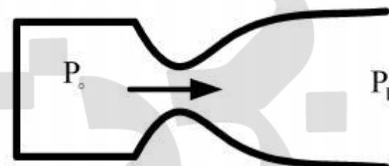
(۱) با تغییرات همزمان  $P_0$  و کاهش  $P_b$  امکان تشکیل موج ضربه‌ای در بخش و اگرای نازل و حرکت آن به سمت بالادست و پایین دست ناحیه و اگرا وجود دارد.
