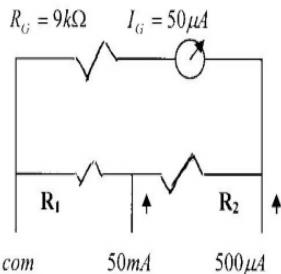
۶۱- برای توسعه حدود اندازه گیری جریان یک گالوانومتر قاب گردان از شنت آترتون مطابق شکل زیر استفاده شده است . مقاومت  $R_1$  چند اهم است ؟
