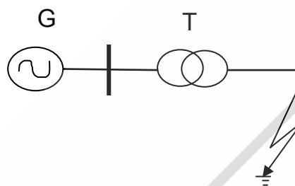
$$T \begin{cases} 17 \text{ MVA} \\ 10/50 \text{ KV} \\ 5\% \end{cases} G \begin{cases} 17 \text{ MVA} \\ 10 \text{ KV} \\ 5\% \end{cases}$$
