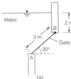
۵۶- در یچه شکل مقابل دارای ابعاد  $3m \times 2m$  می‌باشد و در نقطه B دارای اتصال لولایی است. چنانچه از اصطکاک در نقطه A صرف نظر گردد عکس العمل A چند کیلونیوتن
